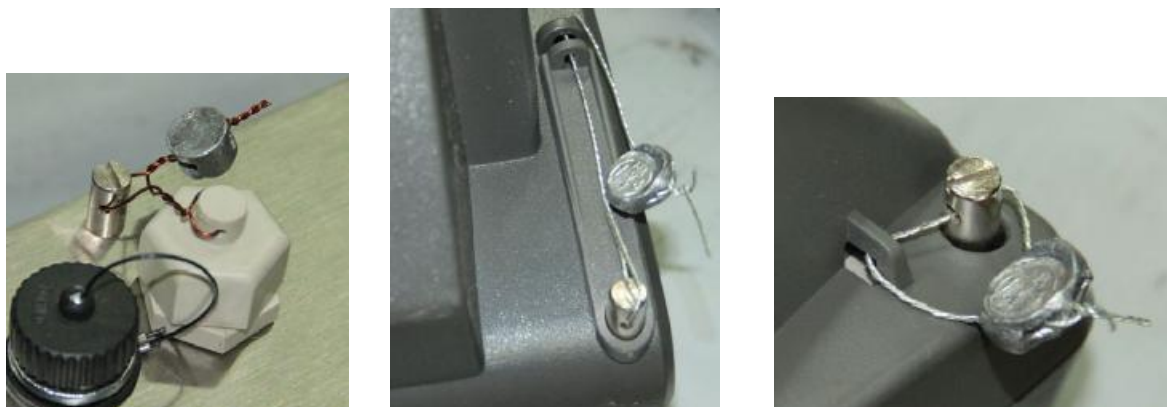
Рисунок 2 — Схема пломбировки весов от несанкционированного доступа
