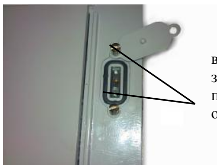
Рисунок 3 — Схема пломбировки весов от несанкционированного доступа. Пломбировка переключателя настройки
